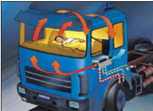
Функциониране на въздушния отоплител.
