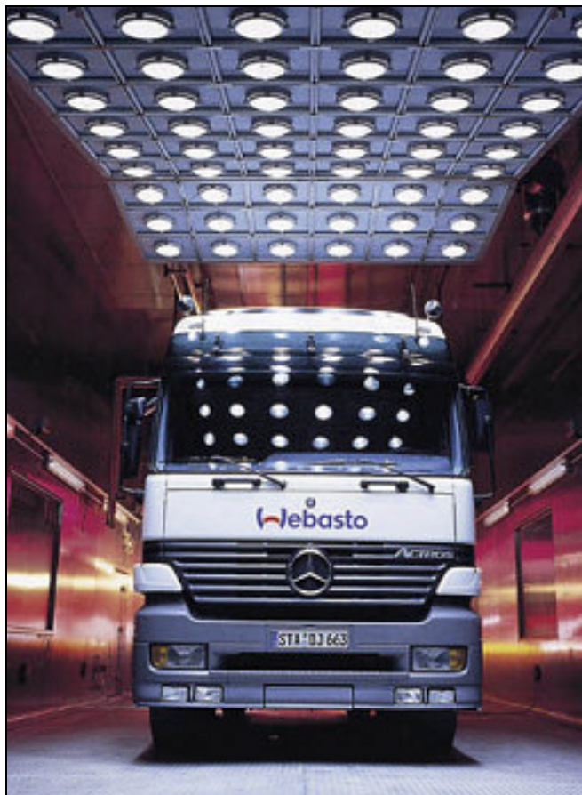
Климатичната камера на Webasto, в която се изпитват отоплителните и климатичните системи.
