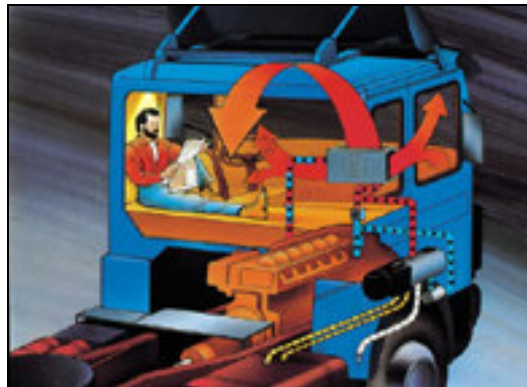
Функциониране на водния отоплител.
